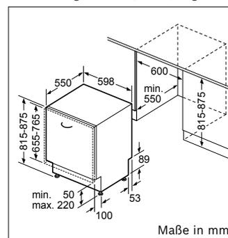
Durch das Vario Scharnier sind Frontgewichte zwischen 4,5 und 11,0 kg möglich, minimale Sockelhöhe 50 mm.
