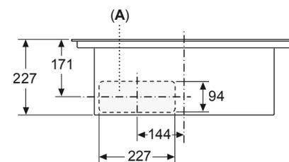
A: Direkt an der Rückseite angeschlossen
