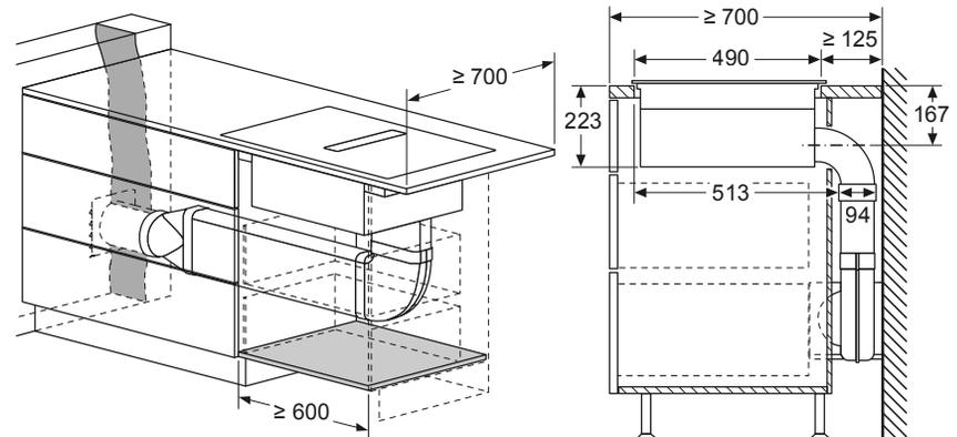
Beispiel Abluft-Führung in den Boden, T47TD7BN2
