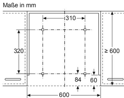
Montage Flachschirmhaube mit Absenkrahmen
