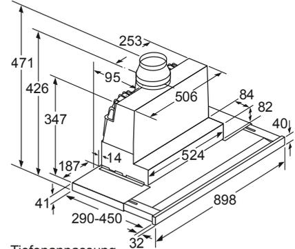
Tiefenanpassung des Filterauszuges bis 29 mm möglich
