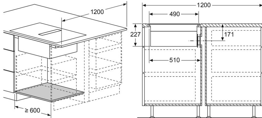
Abluft, mit 90° Flachkanalwinkelbogen vertikal (S-Radius), Arbeitsplattentiefe  $\geq 60$  cm
