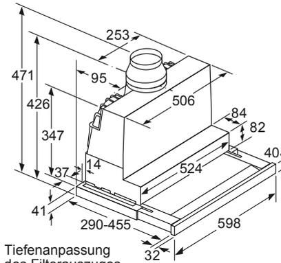
Tiefenanpassung des Filterauszuges bis 29 mm möglich
