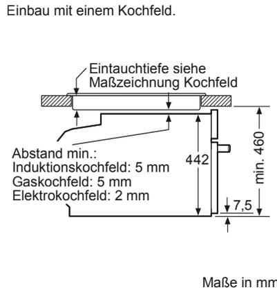
Wird das Kompaktgerät unter einem Kochfeld eingebaut, muss folgende Arbeitsplattenstärke (ggf. inkl. Unterkonstruktion) beachtet werden.
