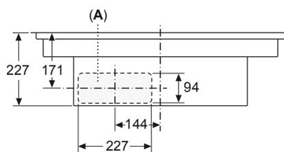
A: Direkt an der Rückseite angeschlossen
