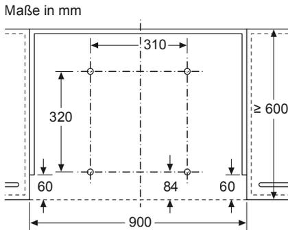
Montage Flachschirmhaube mit Absenkrahmen
