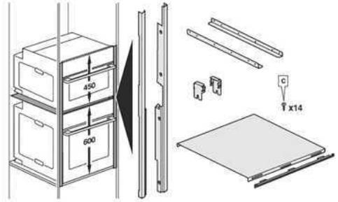
Durchgehende Design-Lisenen zur nahtlosen Kombination eines Slide&Hide®-Backofens mit einem Kompakt-Backofen + Zwischenboden zur Kombination von zwei Backöfen
