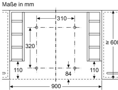
Montage Flachschirmhaube mit Absenkrahmen
