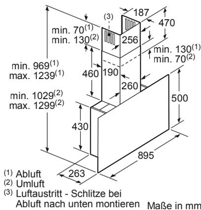
(1) Abluft (2) Umluft (3) Luftaustritt - Schlitze bei Abluft nach unten montieren
