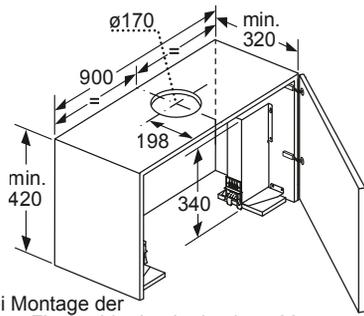
Bei Montage der 90cm Flachschirmhaube in einen 90cm breiten Oberschrank ist ein Montage-Set erforderlich. Die beiden Montagewinkel werden rechts und links ins Möbel verschraubt. Montage nach Schablone.
