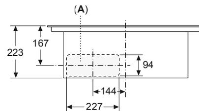
A: Direkt an der Rückseite angeschlossen
