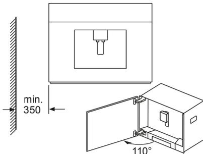
Bei Verwendung der 92° Scharnierbegrenzung (Ersatzteilnr. 00636455) beträgt der Mindestabstand zur Wand nur 100 mm. Maße in mm
