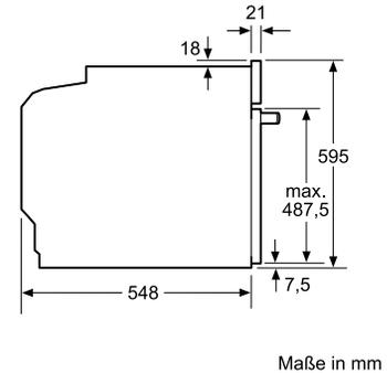
Wird das Gerät unter einem Kochfeld eingebaut, muss folgende Arbeitsplattenstärke (ggf. inkl. Unterkonstruktion) beachtet werden.
