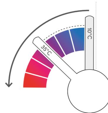
**Anders bei Portare aus der Serie ARMATE® SERVIZIO:** Erst wenn der Mischhebel über die Mitte bewegt wird, fließt heißes Wasser. Steht der Hebel in der Mitte, wird nur Kaltwasser verbraucht. Das senkt die Energiekosten und hilft der Umwelt.
